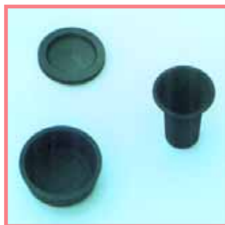
Aufschlußtiegel und Abgußschale, Graphit Graphite fusion crucible and casting dish
