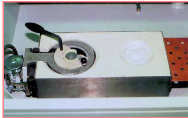
Aufschlußraum mit doppelter Induktionsspule Fusion chamber with double induction coil Lifumat-2.0 Ox
