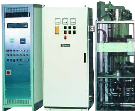
Kristallzuchtssystem für 2" SiC-Kristalle (4H/6H) Crystal growing system for 2" SiC-crystals (4H/6H)
