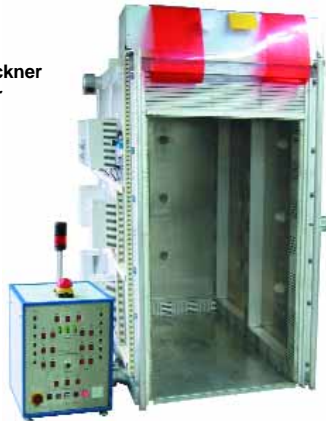
Mikrowellen-Kammertrockner mit Rollenbahn Microwave chamber dryer with roller conveyor 14 m 3 / 25 kW
